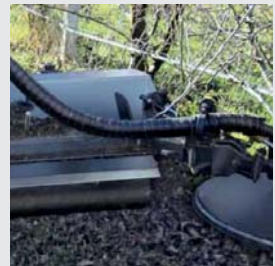
Disco lateral de desl. hidráulico (ligação ao hidráulico do tractor).
