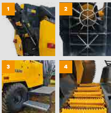
1. Mesa de alimentação integrada (hidráulica); 2. Cunha; 3. Plataforma; 4. Rolos de alimentação recortados.
